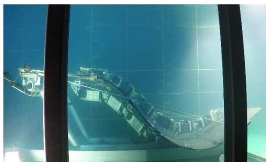
Hydrolienne EEL, prototype d'une puissance de 10KW
